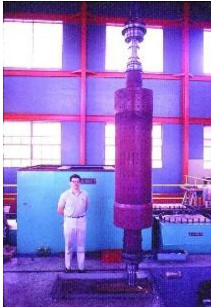
Enseguida el rotor del generador, con el Ingeniero Mecánico Mariano Hermosillo Vives. La unidad era de 5000 kW, 6250 kVA, 0.8 factor de potencia, directamente en 13 800 volts, marca Elliot.
