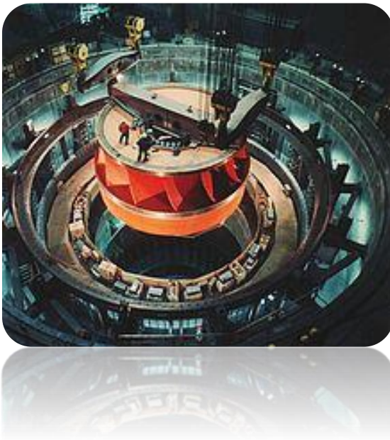
En la foto, turbina Francis moderna de 750 MW.
