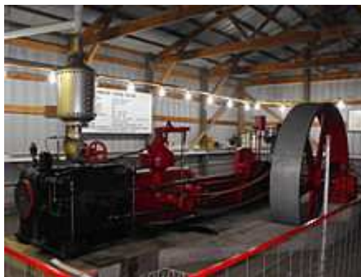
Un motor estacionario de tipo Corliss, marca Allis-Chalmers.
