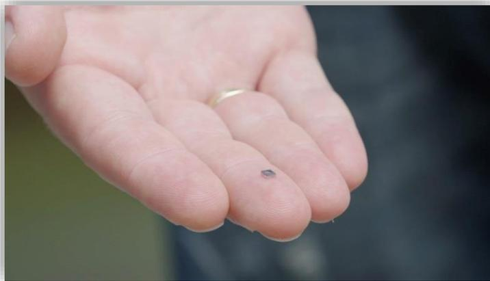
En la foto de un lado vemos una mano con el micrófono en uno de sus dedos. Es de la marca noruega sensiBel que ha hecho experimentos sobre la base de un pequeñísimo rayo láser para observar mediante un interferómetro el movimiento de una membrana con base de
